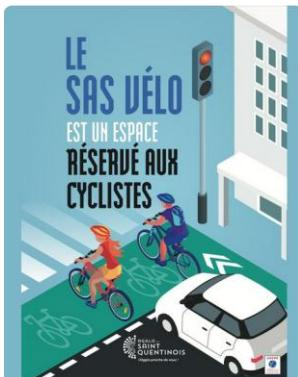
C'est un espace destiné aux cyclistes sur un carrefour à feux tricolores. Il se situe entre le feu tricolore et la ligne pointillée devant laquelle doivent s'arrêter les voitures. Il est remarquable par ses deux lignes et rempli d'un marquage au sol en forme de vélo.
